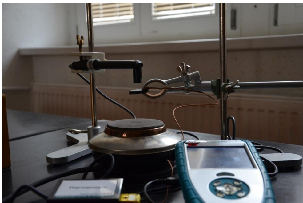
Slika 5: Prikaz eksperimenta pri merjenju magnetnega polja glede na odvisnost temperature
