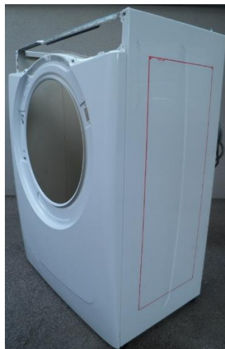
Slika 47: Model stroja z izvzetim notranjim delom in narisanimi črtami za izrez (vir: avtor naloge)
