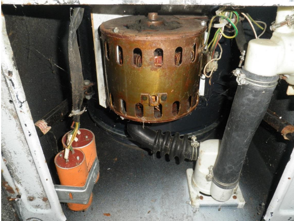
Slika 6: Enofazni indukcijski motor in kondenzatorja v stroju Superavtomat (vir: avtor naloge)
