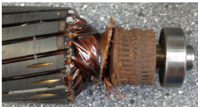
Slika 10: Rotor z uničenim kolektorjem (vir: avtor naloge)
