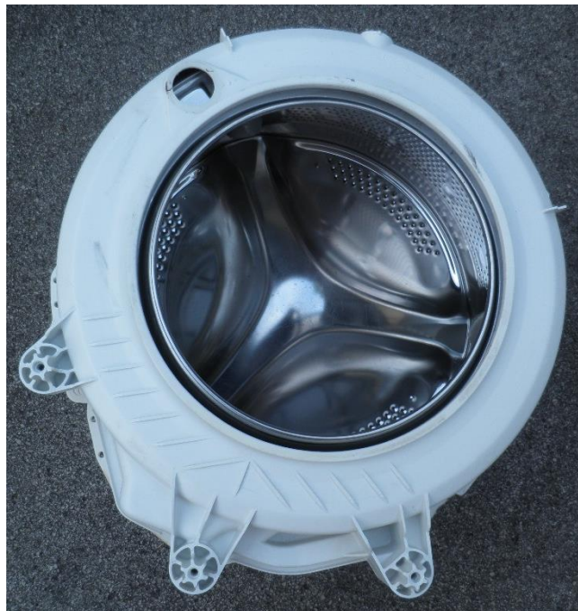
Slika 23: Plastična kad iz novega stroja uporabljena v modelu (vir: avtor naloge)
