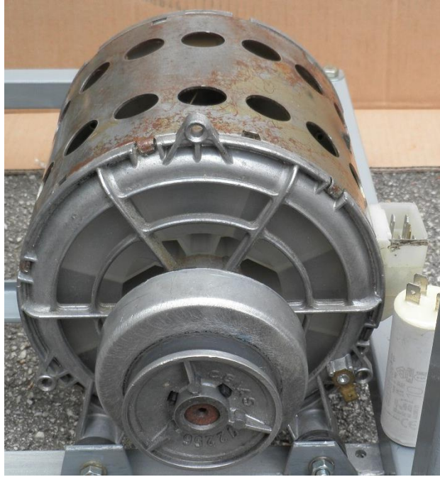
Slika 5: Enofazni indukcijski motor v modelu (vir: avtor naloge)
