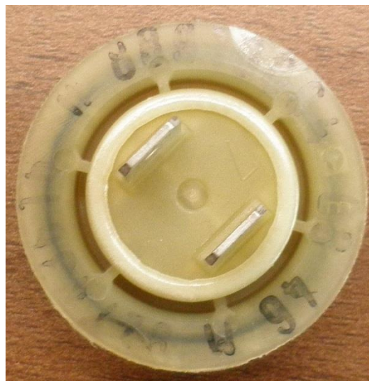
Slika 21: Senzor temperature (NTC-upor) (vir: avtor naloge)
