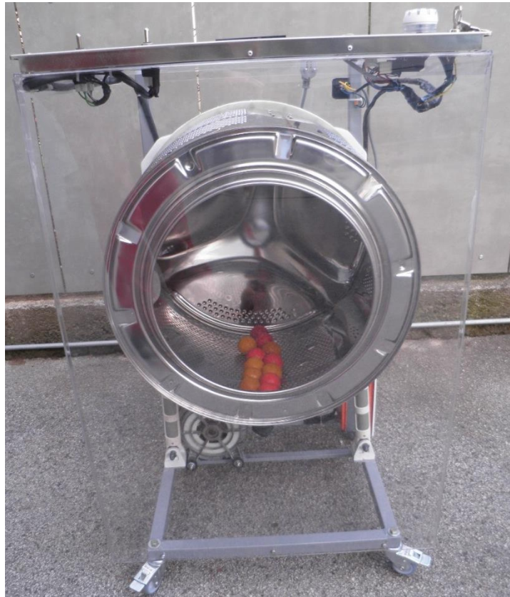
Slika 42: Model za prikaz delovanja motorja in bobna (vir: avtor naloge)
