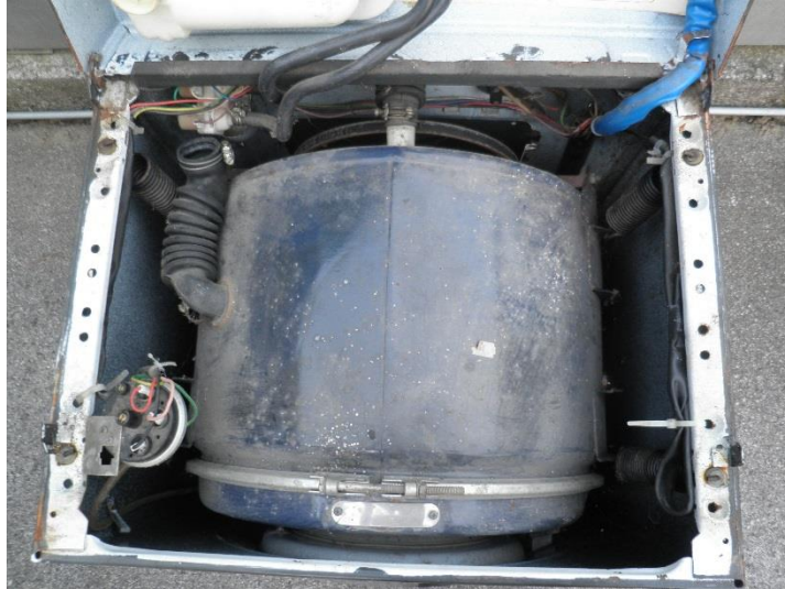
Slika 22: Emajlirana kad iz starega stroja (vir: avtor naloge)
