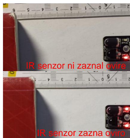
Slika 10: Delovanje IR senzorja (vir: Avtor naloge)
