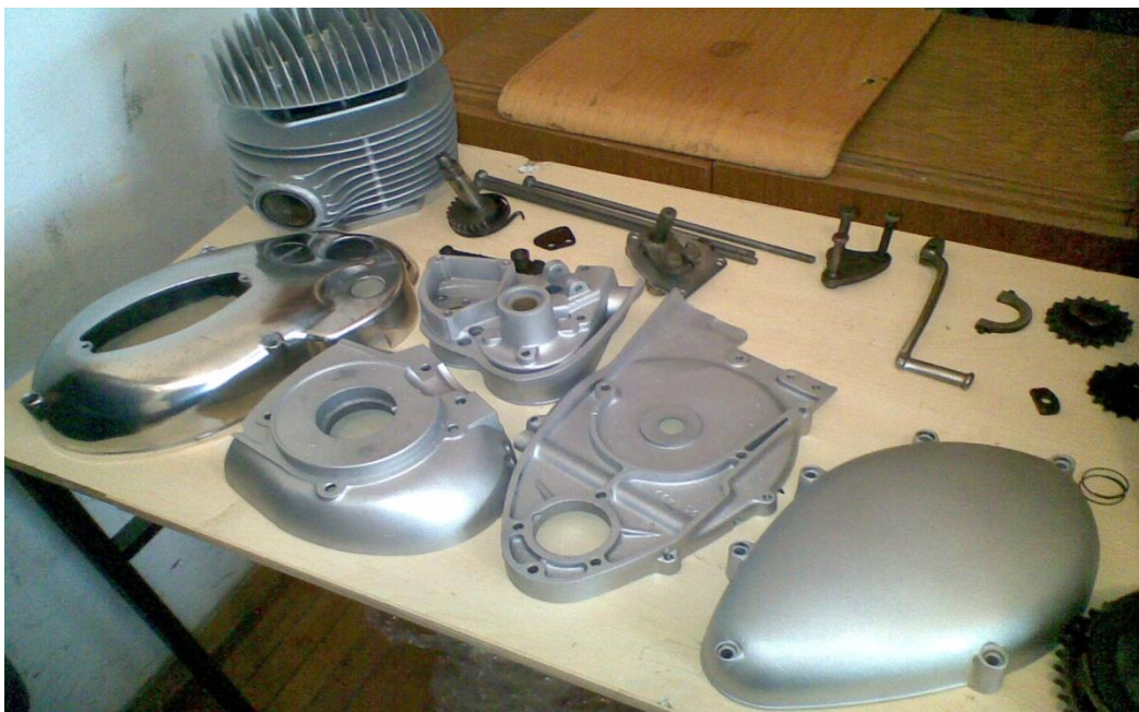
Slika 17: peskani in pobarvani ali spolirani deli motorja
