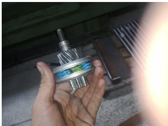
Slika 42: Sklopka z novim parom dveh vzmeti (zelena barva vzmeti)
