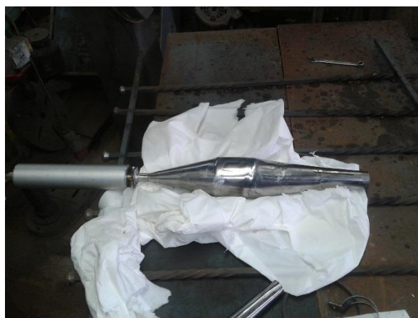
Slika 55: Zavarjen izpuh z dušilcem
