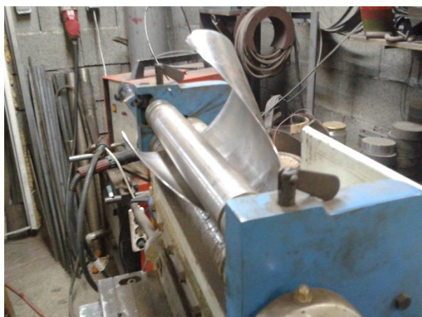
Slika 52: Upogibanje pločevine v konus
