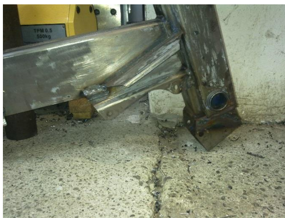
Slika 34: Ojačani zvari na nosilcih motorja
