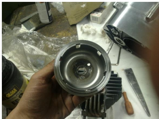
Slika 43: Izdelovanje ojačitvenega obročka
