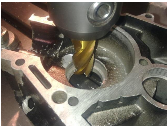
Slika 21: Frezanje v globino za 1mm
