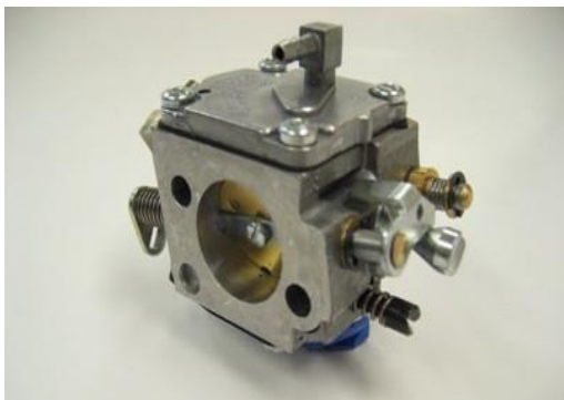
Slika 12: Uplinjač Tillotson (membran)
