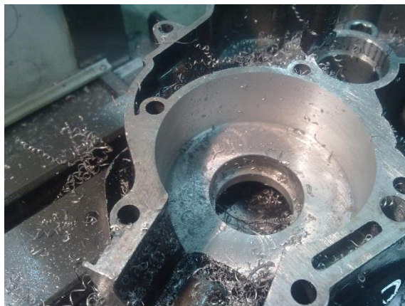
Slika 22: Struženje po premeru za 5mm
