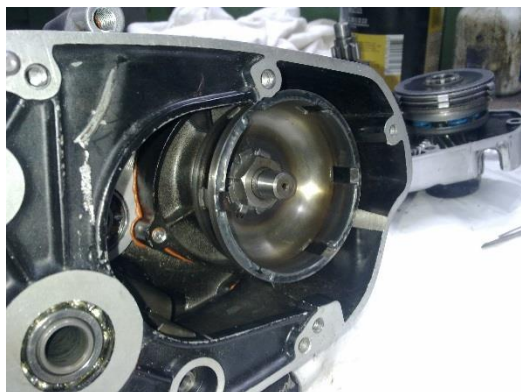
Slika 44: Končan zvon nameščen na gred, v ozadju pa sklopka z lamelami.
