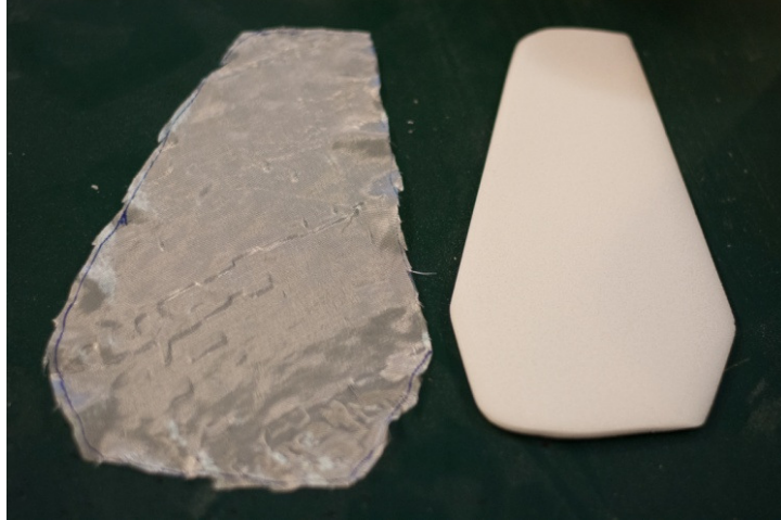
Slika 36: Izrezana steklena tkanina pripravljena za laminiranje na rohacell
