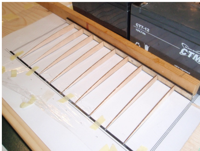
Slika 34: Lepljenje reber k remenjači
