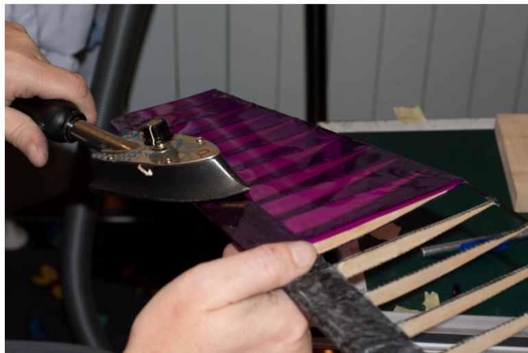
Slika 37: Prekrivanje modela s termo folijo
