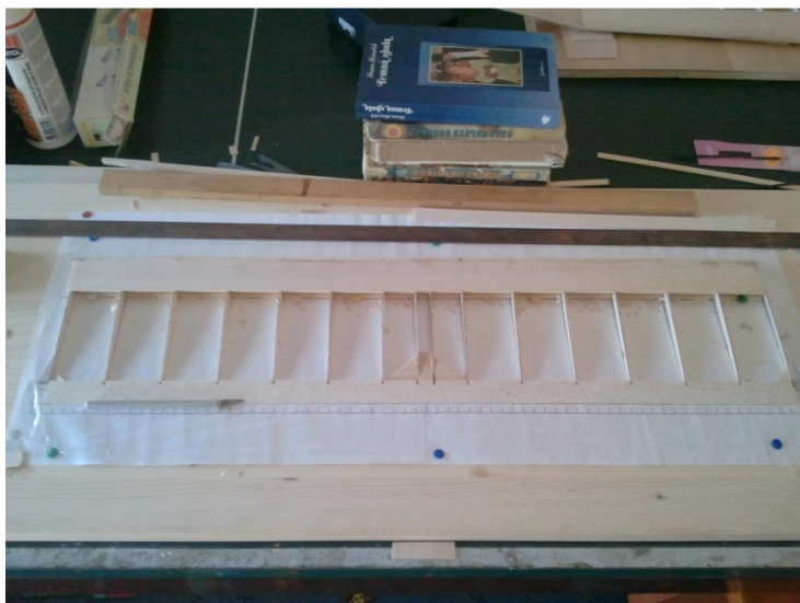
Slika 28: Izdelava centropлана oz. srednjega segmenta krila
