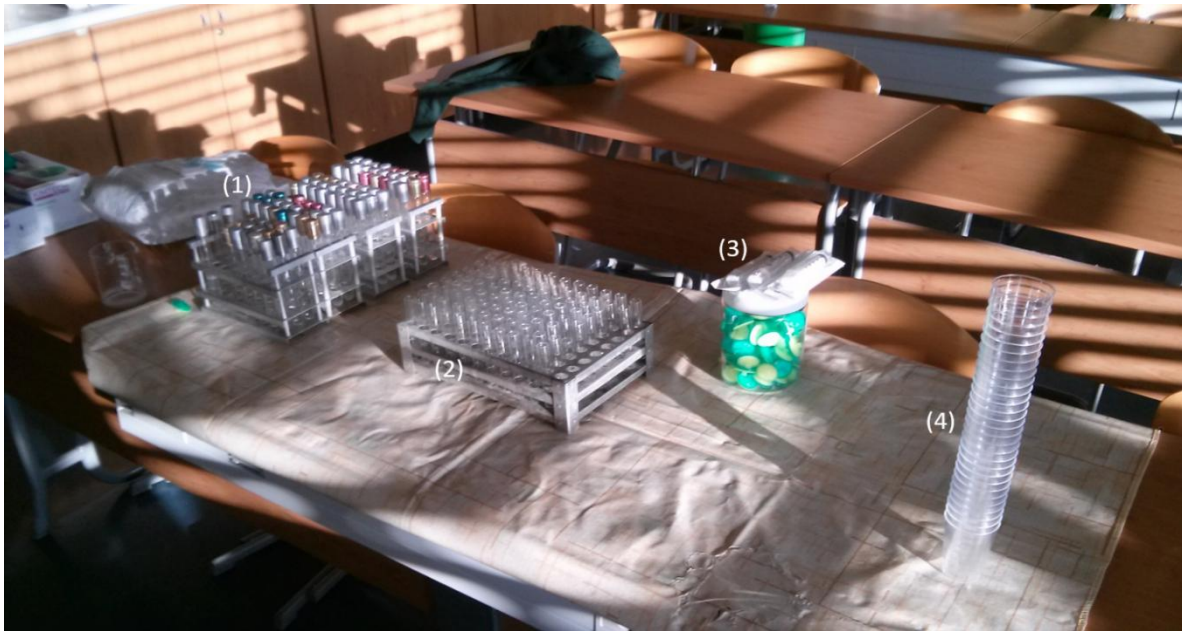
Slika 10: Oprema pred začetkom filtriranja: (1) = epruvete z vzorci po štirih dneh; (2) = pripravljenih 90 manjših epruvel; (3) = posoda s filtrirnimi nastavki in injekcijske brizge; (4) = plastični kozarci za prečrpavanje filtrata (lastni vir)
