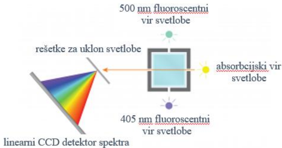
Slika 6: Prikaz delovanja spektrofotometra (shema prirejena po Vernier http://www.vernier.com/products )
