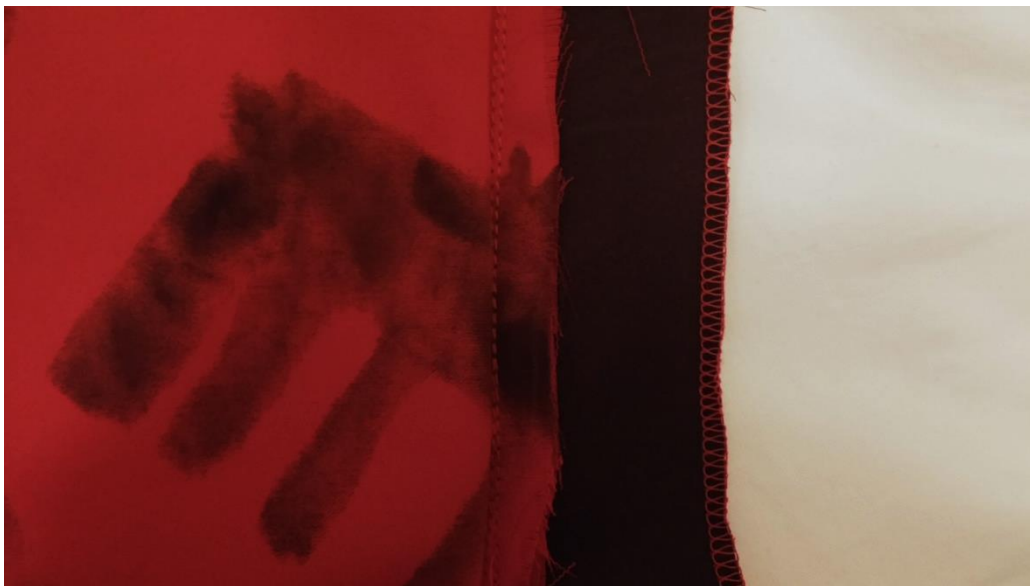
Slika 55: Črn del je centilin, prilepljen na obrobo, ki je zarobljena [18]
