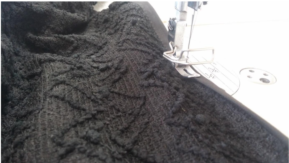
Slika 60: Obrobljanje vratnega izreza s paspulo [18]
