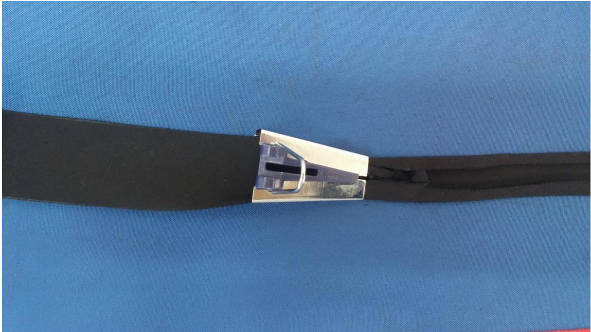
Slika 59: Pripomoček za izdelavo paspule [18]
