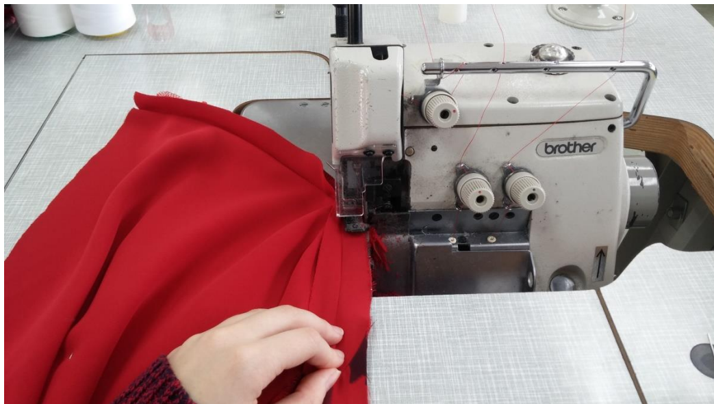
Slika 53: Robljenje bočnega dela obleke (primer razlikanega dodatka) [18]
