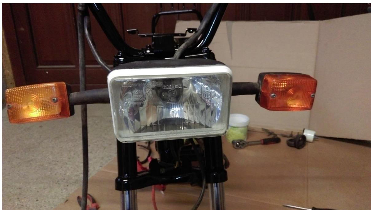
Priklopljena sprednja luč in sprednji smerniki
