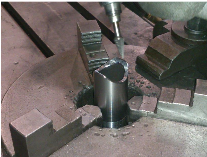
Slika 19: Posnemanje robov (avtor slike: Piseč naloge)
