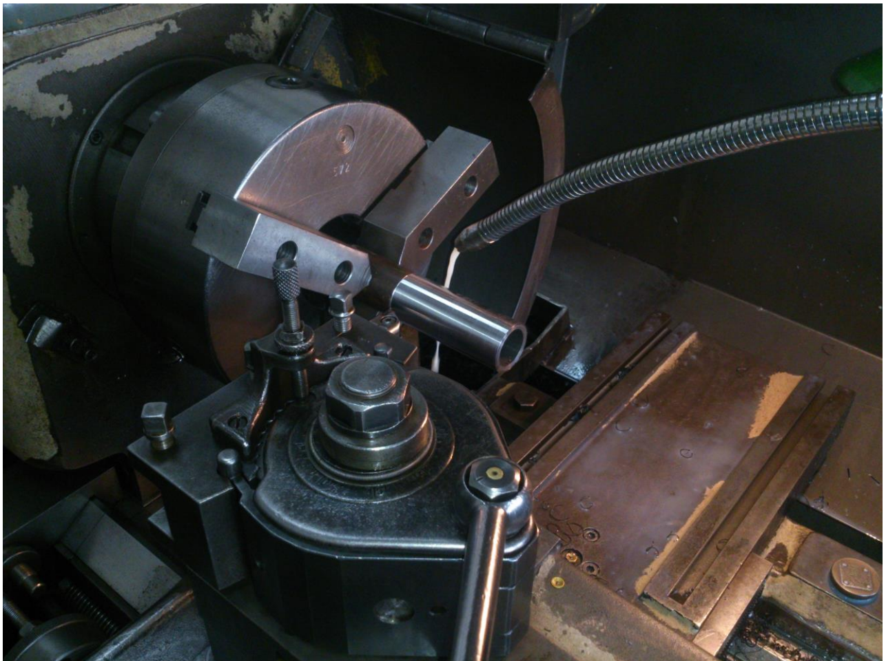
Slika 22:Struženje cevi (avtor slike: Pisec naloge)
