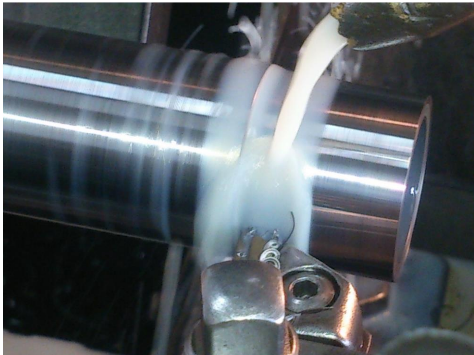
Slika 23:Struženje sedeža za navoj (avtor slike: Pisec naloge)
