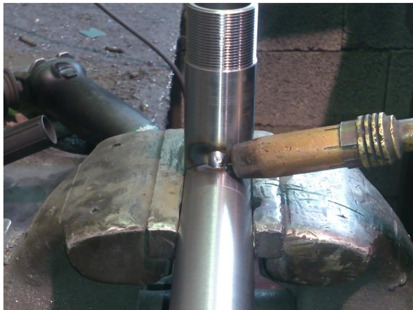
Slika 15:Varjenje MIG (avtor slike: Pisec naloge)
