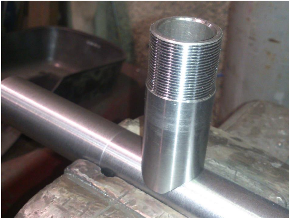
Slika 31: Sestava pred varjenjem (avtor slike: Pisec naloge)
