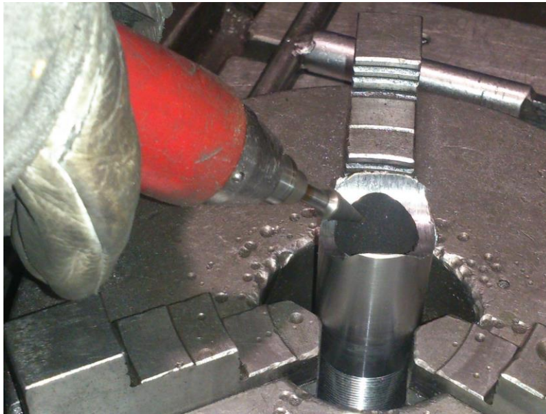
Slika 18: Posnemanje robov (avtor slike: Piseč naloge)
