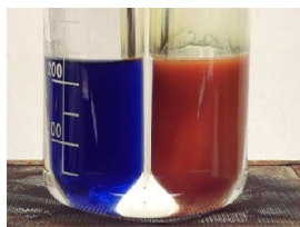
SLIKA 4 – POZITIVEN FEHLING TEST (DESNO) ZA ENCIMSKO HIDROLIZO BIOPLASTIKE
