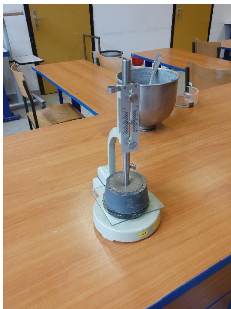
Slika 11: Vicatov aparat v uporabi [Vir: Avtorjeva osebna zbirka]
