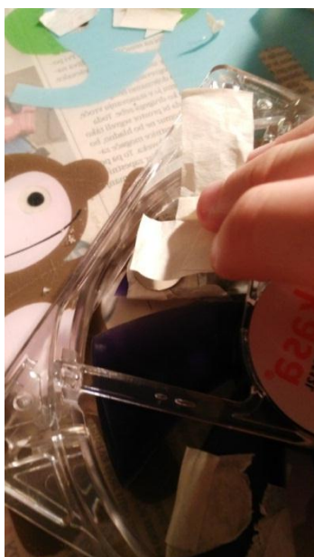
Slika 11: Potek lepljenja magnetov na lopatico
