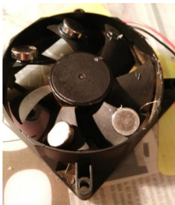
Slika 7: Prototip magnetno ventilacijskega generatorja
