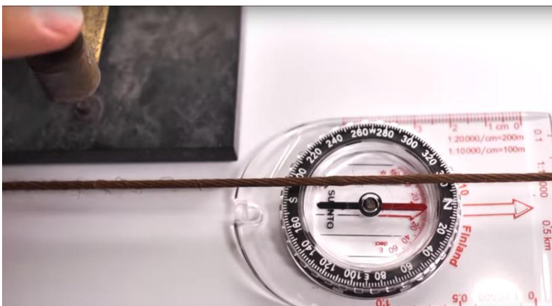
Slika 2: Stanje kompasu pri žici brez električnega toka
