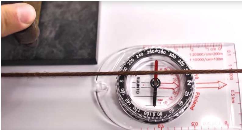
Slika 3: Stanje kompasa pri žici skozi katero teče tok
