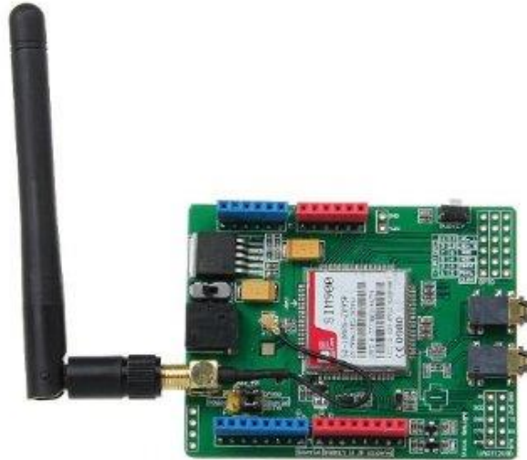
Slika 2: GSM modul (vir: ecx.images-amazon.com ).
