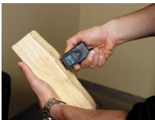
Slika 31: Merjenje vlažnosti lesa
