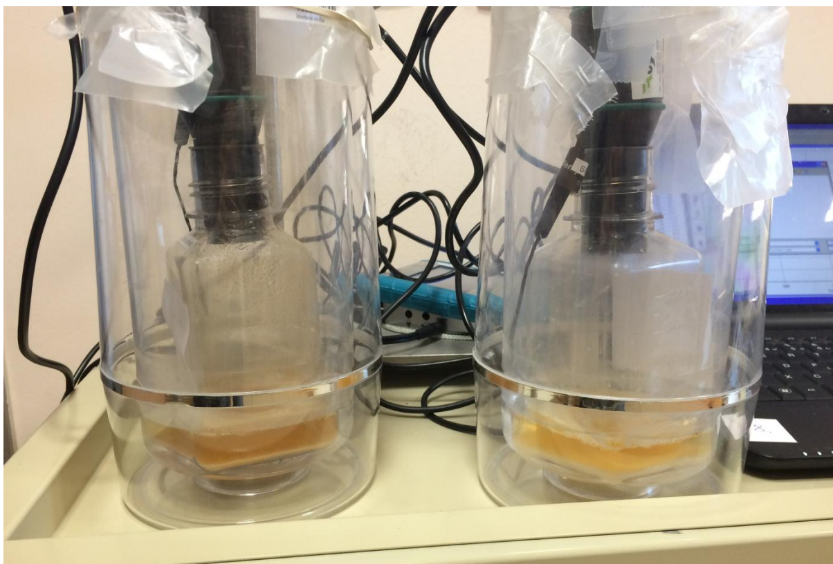
Slika 15: Nastavljen poskus dveh vzorcev hkrati z merilnikoma temperature in kisika povezanim z vmesnikom Vernier (v ozadju) in računalnikom (desno) (avtor raziskovalne naloge)
