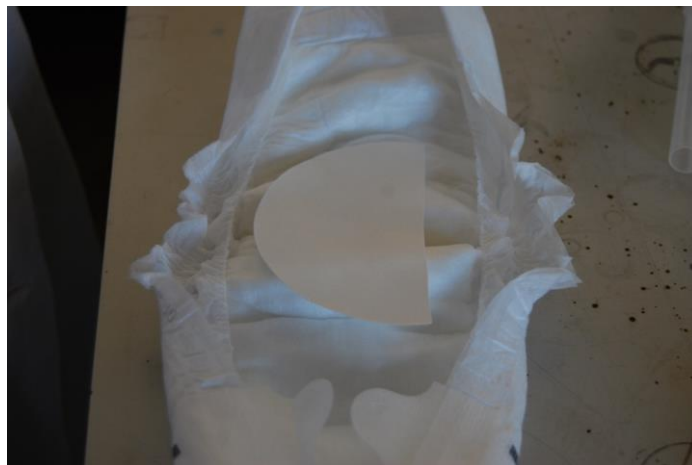
Slika 27: S filtrirnim papirjem smo preverjali vlažnost površine plenice. (lastni arhiv)
