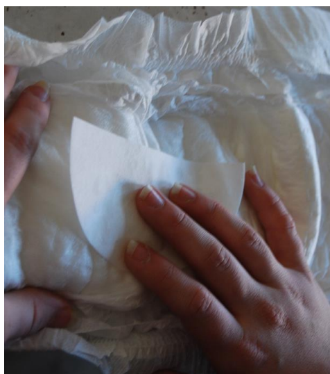
Slika 28: Filtrirni papir smo rahlo naslonili na površino in nato določili vlažnost (malo, srednje, zelo). (lastni arhiv)
