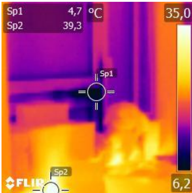
Slika 10: Na sliki so vidne velike temperaturne izgube skozi okno, pod njim pa je žareč radiator.
