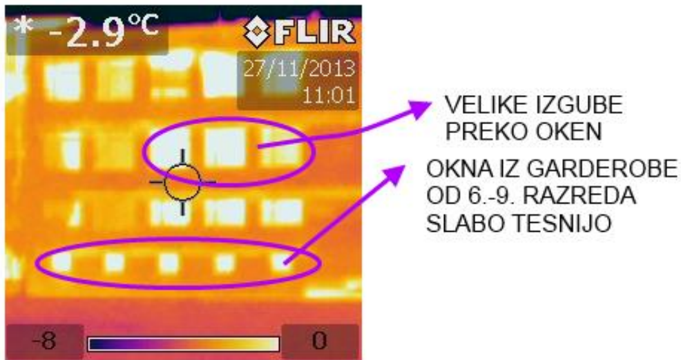
Slika 2: Velike izgube toplote skozi okna učilnic, zaradi slabih tesnil in zastarelosti oken. Opazijo se tudi velike toplotne izgube skozi fasado šole.
