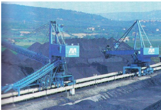
Slika 8: odlagalec in nakladalec razsutih tovorov v Luki Koper
