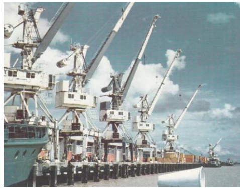
Slika :7 vrtljivi portalni žerjavi v luki Chalna, Bangladeš
