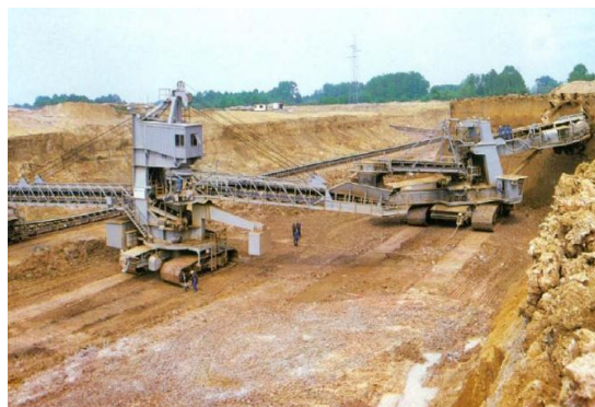
Slika 9: samohodni transportni trak, dnevni kop Rudnika Omarska
