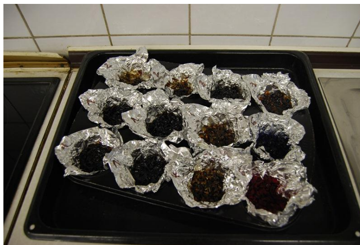
Slika 9: Vzorci 1-5 po segrevanju v ventilacijski pečici pri temperaturi nad 230°C
