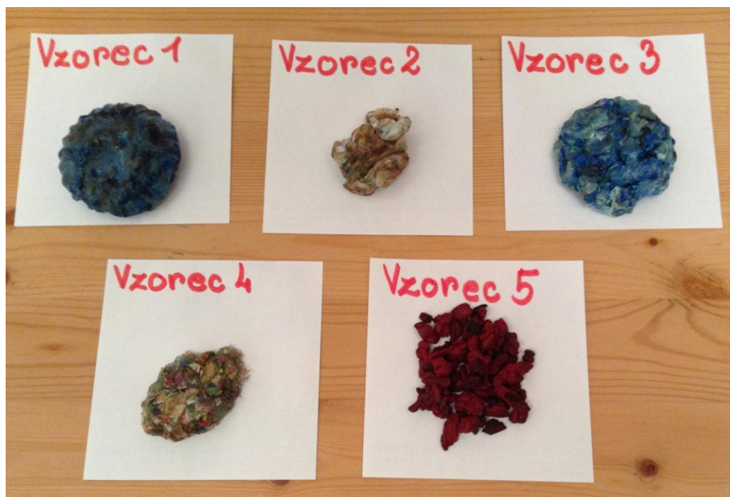
Slika 7: Vzorci 1-5 dobljeni pri segrevanje uporabljenega odpadnega plastičnega materiala na plinskem gorilniku
