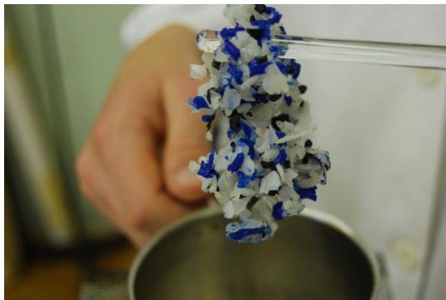
Slika 5: Vzorec 3 po segrevanju s špiritnim gorilnikom
