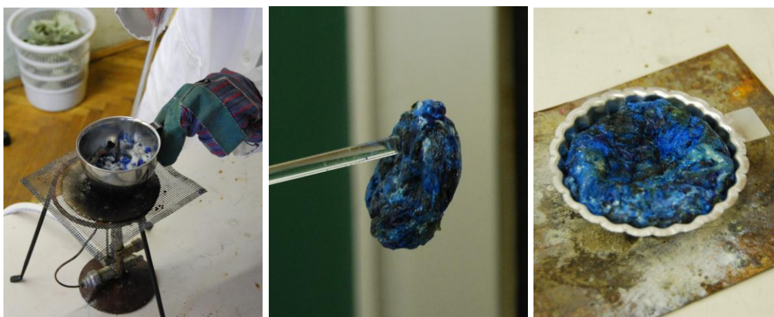
Slika 6: Vzorec 3 med in po segrevanju s plinskim gorilnikom
