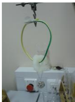
Slika 5: Prirejen poskus upogibne trdnosti
