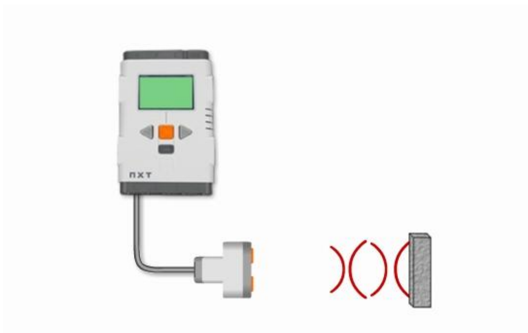
Slika 22 – Delovanje ultrazvočnega senzorja
