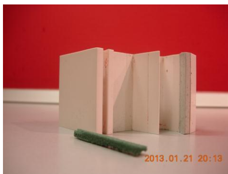
Slika 10: Oblikovanje tesnilnega elementa
