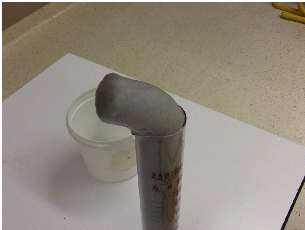
Slika 4: pena pri reakciji z manganovim dioksidom (avtor naloge, 2013)
