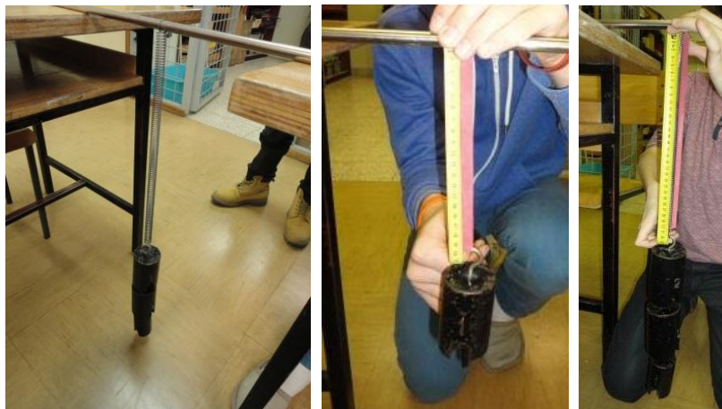
Slika 7: Določanje konstante vzmeti, elastike ter vzmeti in elastike skupaj
