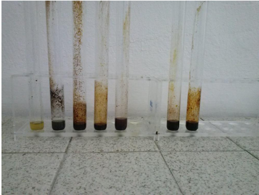
Slika 8: Slika eksperimenta s kloroformom in aluminijevim trikloridom(od leve proti desni: brez katalizatorja, vrelnimi kamenčki, opeka, cement, \text{FeSO}_4 , perlit, cink in pasta za lotanje)
