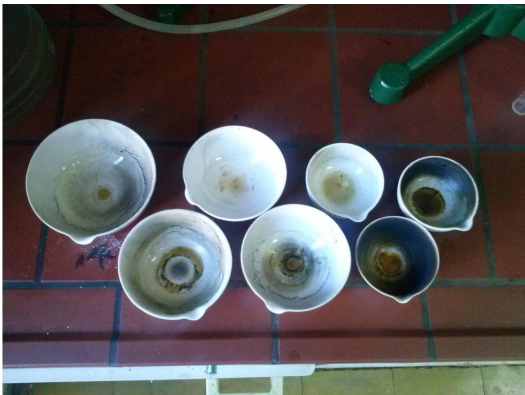
Slika 9: Preostanki žgalnega preizkusa (od leve proti desni: perlit, vrelni kamenčki, cement, \text{FeSO}_4 , opeka, pasta za lotanje in cink)
