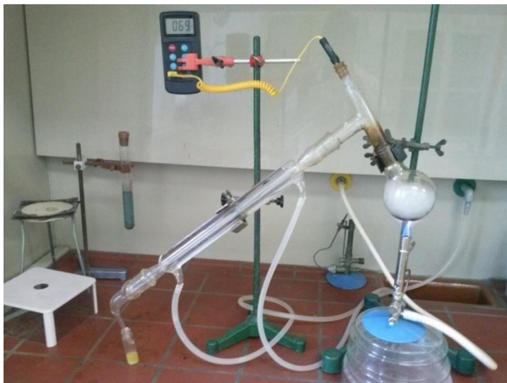
Slika 3: Aparatura za pirolizo PE vrečk v šolskem laboratoriju
