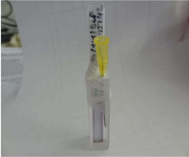
Slika 5: Komplet kivete, membrane in kanile za dodajanje ustrezne puferne raztopine
