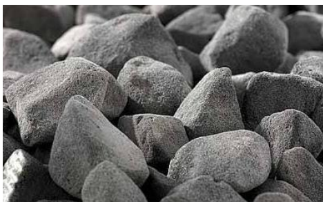
Slika 57: Penjeno steklo kot granulat
