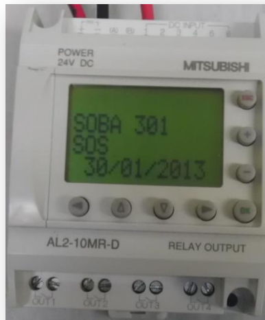
Slika 5: Krmilnik Alpha Mitsubishi (vir: avtor naloge)
