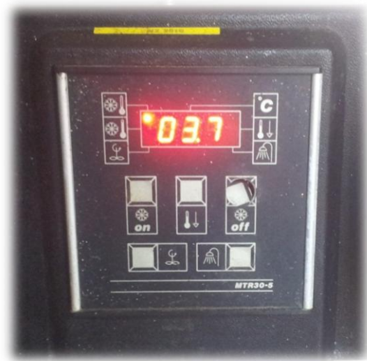
Slika 23: Krmilni del mlečnega bazena z napisom temperature mleka (vir: avtor naloge)
