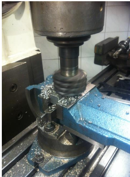
Slika 12: Frezanje pritrdilnega elementa
