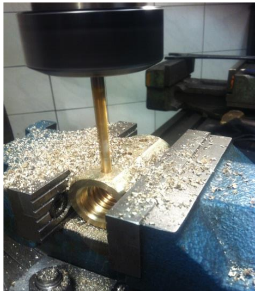
Slika 18: Frezanje izvrtine matice
