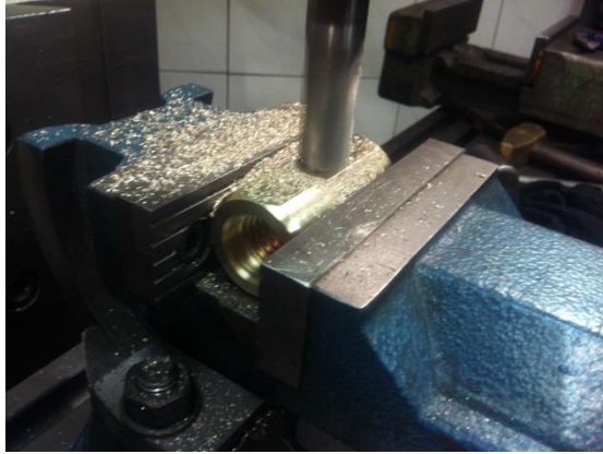
Slika 17: Frezanje zgornje ploskve matice
