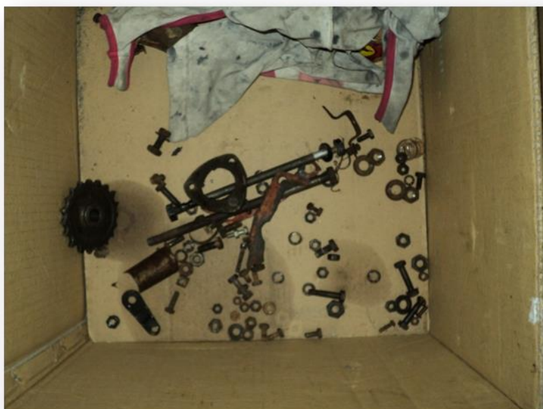
Slika 4: Razstavitev ročic in vzmeti
