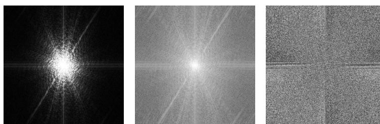
Slika 42: Magnituda Fourierjeve transformacije v linearni kvantizaciji (levo) in logaritmski kvantizaciji (sredina) ter faza Fourierjeve transformacije (desno)
