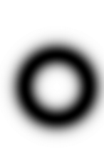
Slika 50: Gaussov pasovnozaporni filter velikosti 512 \times 512 , \sigma = 25 , \mu = 100
