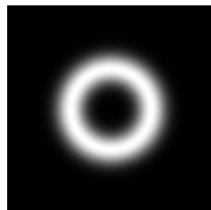
Slika 49: Gaussov pasovnoprepustni filter velikosti 512 \times 512 , \sigma = 25 , \mu = 100
