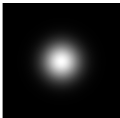
Slika 47: Gaussov nizkoprepustni filter velikosti 512 \times 512 , \sigma = 55
