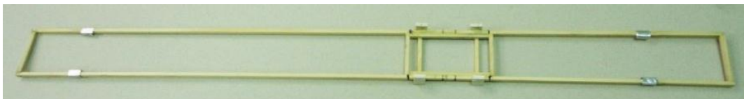
Slika 14 Podvozje vozila na pogon z mišelovko na vzmet (vir: avtorja)
