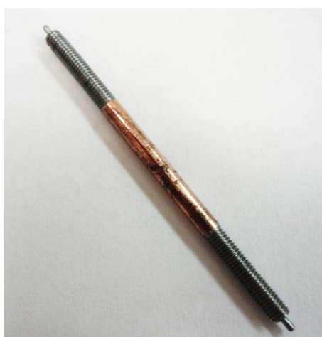
Slika 11 Gred (os), izdelana iz varilne palice s premerom 3 mm (vir: avtorja)
