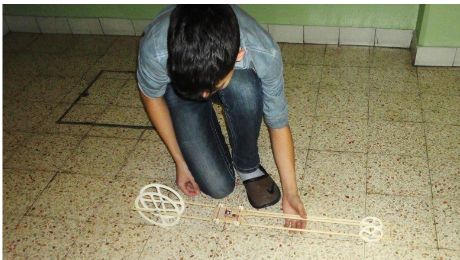
Slika 21 Testiranje vozila na pogon z mišelovko z vzmetjo (vir: avtorja)
