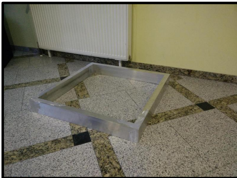
Slika 3: ALU okvir računalniško krmiljenega rezkalnika
