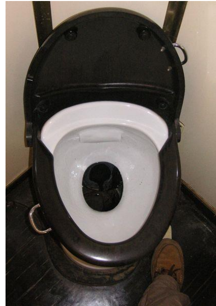
Slika 22 Tradicionalno stranišče na vlaku s stopalko za izpust
