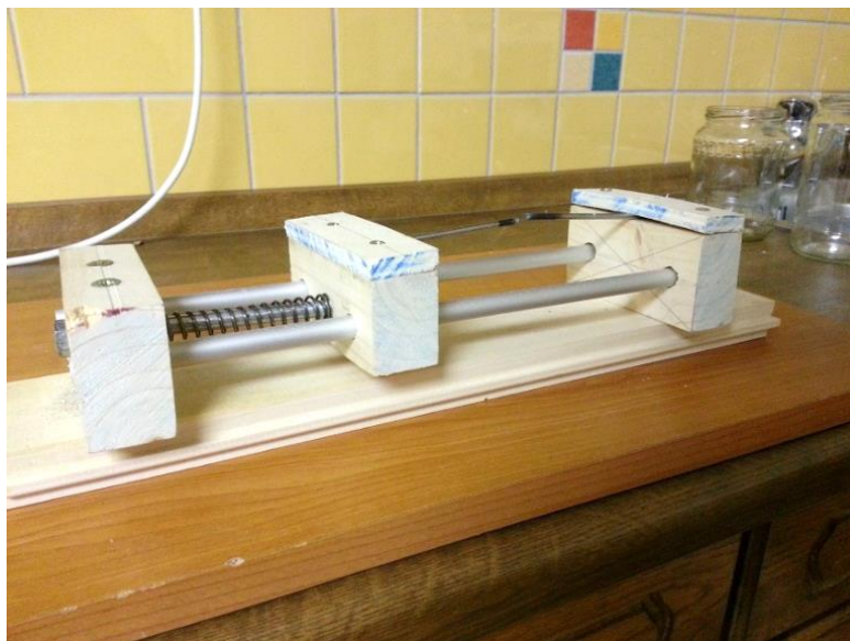
Slika 13: Izdelano iskrišče. (vir: avtorska slika)
