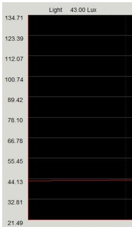
Slika 12: Meritev osvetljenosti pri Varčni sijalki (Vir: Avtor naloge)
