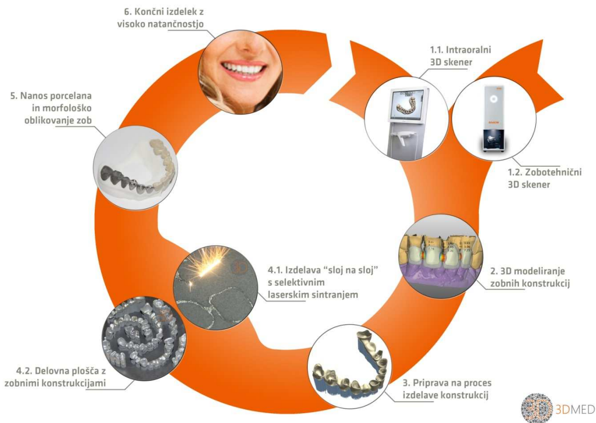
Slika 3 Postopek izdelave zob s 3D tehnologijo
