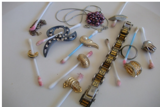
Slika 10: Star, družinski modni nakit, obarvane vatirane palčke dokazujejo prisotnost niklja v izdelku
