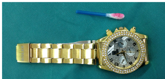
Slika 14: Ura in vatirana palčka z indikatorjem DMG, ki je nanjo pozitivno reagiral
