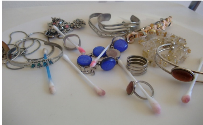
Slika 7: Modni nakit s stojnic z ročno izdelanim nakitom, obarvane vatirane palčke dokazujejo prisotnost niklja v izdelku.
