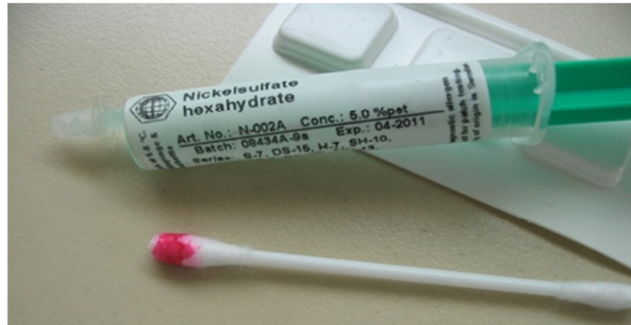
Slika 5: Preizkus učinkovitosti indikatorske raztopine DMG z nikljevim sulfatom heksahidratom
