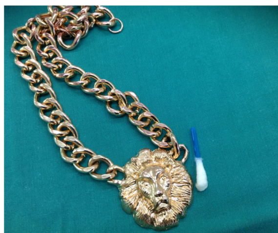
Slika 15: Modna kovinska ogrlica, neobarvana vatirana palčka z indikatorjem DMG
