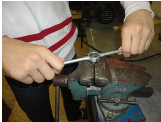
Slika 15 Vrezovanje navojev na gred / os koles elastomobila
