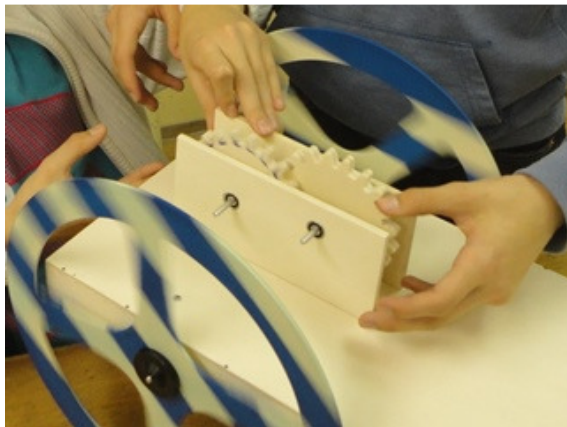
Slika 17 Preizkus delovanja zobniškega prenosa na elastobilu
