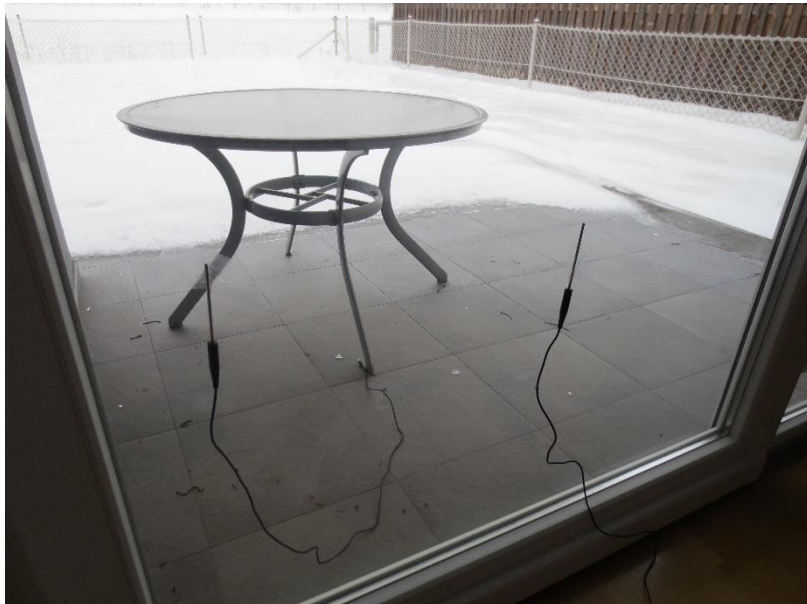
Slika 4: Merjenje temperature na zunanji in notranji strani stekla. (povzeto po lastnem arhivu)
