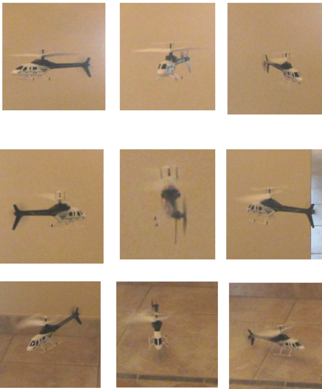
Slika 17. Vrtenje helikopterja po »odpovedi« repnega rotorja. (lasten arhiv).
